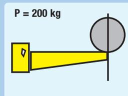
Bei **Verschiebung** des Lastschwerpunktes nach außen bitte um Rückfrage!
